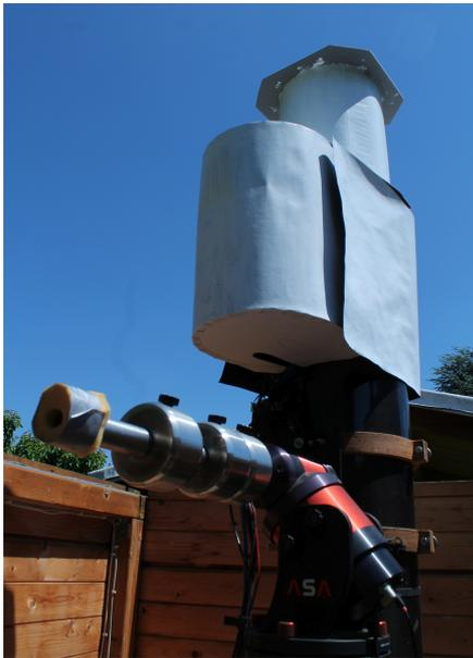
*Abb. 1: 25cm Newton Teleskop mit Abschirmung*
